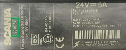
Il "Part number" dovrà essere programmato nel nuovo tachigrafo (prima che quest'ultimo sia stato attivato). I campi di *Softwarenumber* e *Hardwarenumber* rimangono vuoti (vedi immagine successiva) **Nota:** Programmare correttamente il tachigrafo universale DTCO 4.1 attraverso la normale funzionalità di *Programmazione universali*, scegliendo il corretto file di configurazione Scania.
