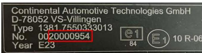
**Novità!!** La programmazione (nel nuovo DTCO 4.1) della matricola del vecchio tachigrafo installato, farà in modo che il nuovo tachigrafo sia correttamente riconosciuto dalla centralina del veicolo.
